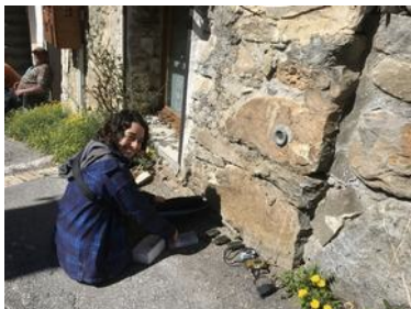
Ruth calant les GPS à proximité immédiate d'un repère géodésique de l'IGN
